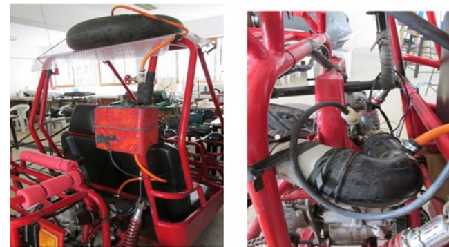
Figura 9. Detalle del sistema de abastecimiento de biogás y su conexión al carburador.
