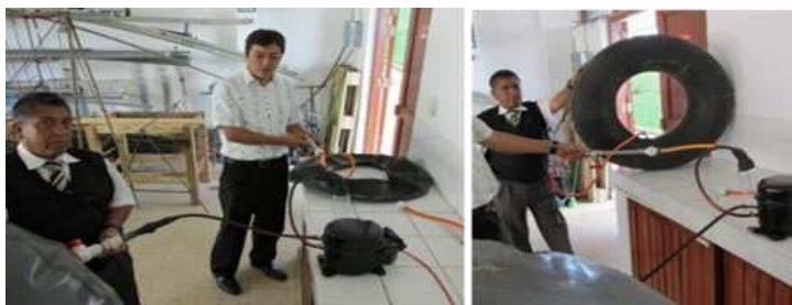
Figura 4: Inicio y fin del trasvase de biogás del balón a la cámara de llanta
